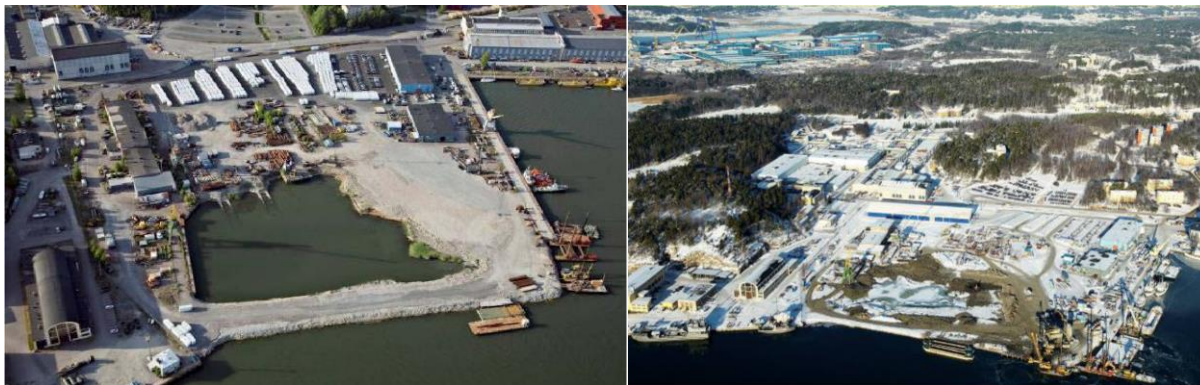
1.3.29 pav. Pansio uosto dalis, atskirta nuo pagrindinės lagūnos akmenų pylimu (kairėje) ir suformuota nauja sausumos teritorija iš stabilizuotų nuosėdų (dešinėje).
