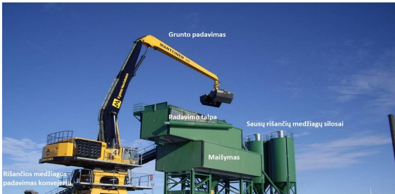
1.3.12 pav. Užteršto grunto apdorojimo technologinio proceso pavyzdinė schema (Turku uostas, Suomija, STABLE. LIFE06 ENV/FIN/195)
