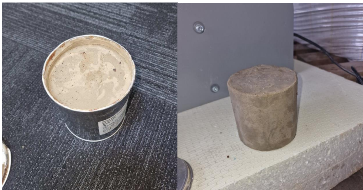
1.3.21 pav. Suformuotas modifikuoto grunto bandinys (d=100 mm, h=100 mm)
