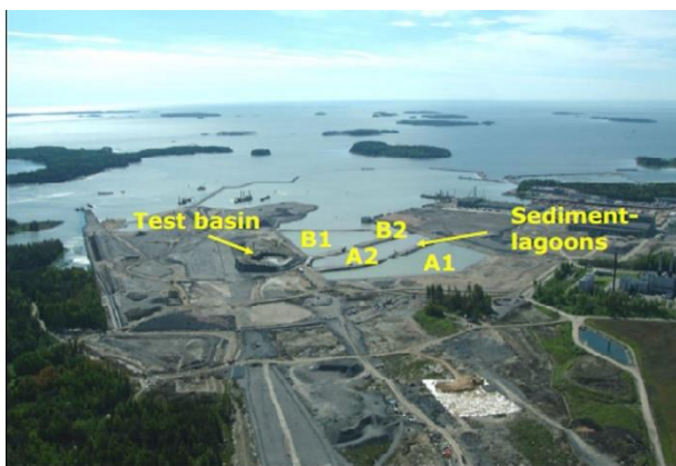
1.3.28 pav. Įrengtas testavimo baseinas bei atskirtos lagūnos grunto stabilizavimo darbams vykdyti (kairėje) ir TBA junginiais užteršto grunto stabilizavimo darbai lagūnoje A1 (dešinėje).
