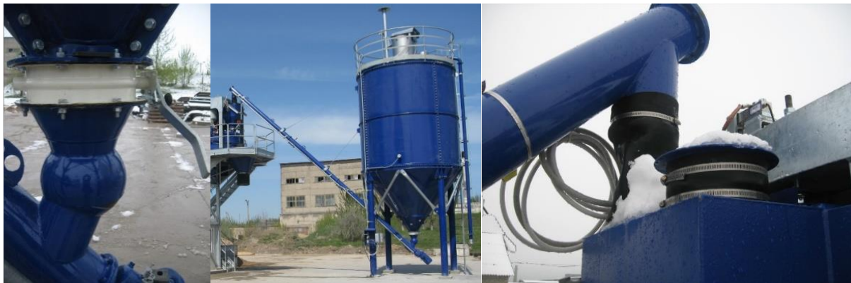
1.3.11 pav. Sraigtinis konvejeris, transportuojantis cementą iš siloso į maišymo mazgo cemento dozatorių.
